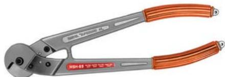
Teste in acciaio di altissima resistenza 65 HRC, per funi con fili d'acciaio extra duro e cavi elettrici con anima in acciaio. Bracci nervati in lega d'alluminio, con impugnature ricoperte in plastica. Lame con profilo avvolgente per la perfetta recisione delle funi.
